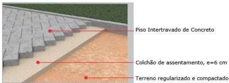
Figura 1. Esquema de assentamento do piso de concreto intertravado pré-moldado.
